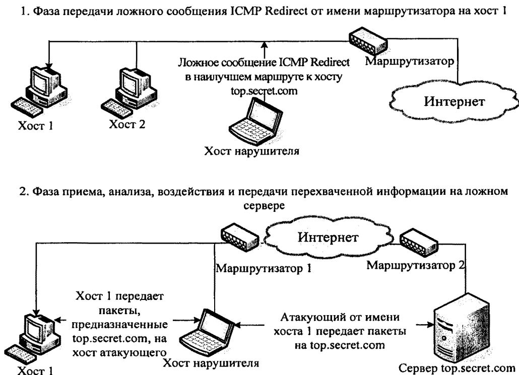
Рисунок 8. Схема реализации атаки "Навязывание ложного маршрута" (внутрисегментное) с использованием протокола ICMP с целью нарушения связи
